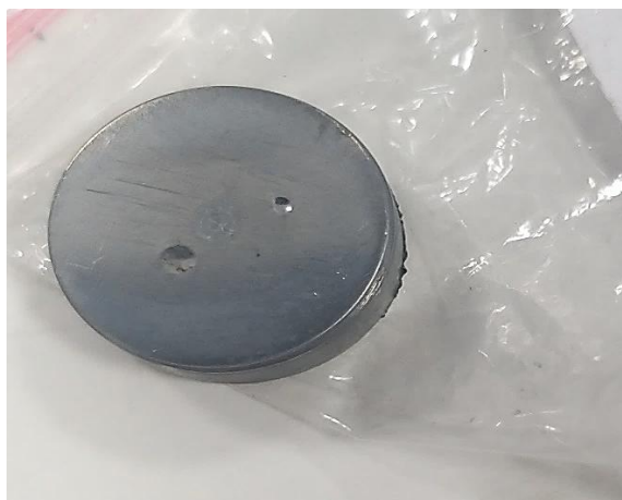
Рис. 1. Образец из цинкового сплава ZnAl1.0Ni0.5 с литием (1.0 мас.%)
