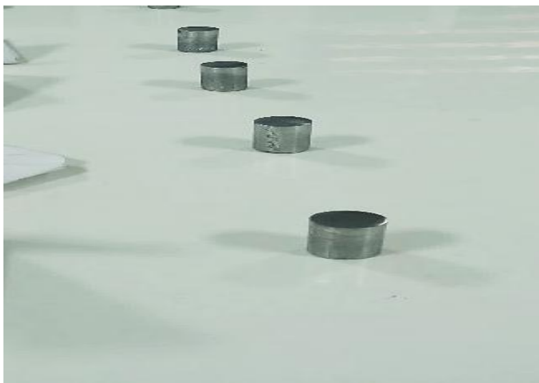
Рис. 1. Образцы из цинкового сплава ZnAl1.0Ni0.5 с натрием для исследования микроструктуры
