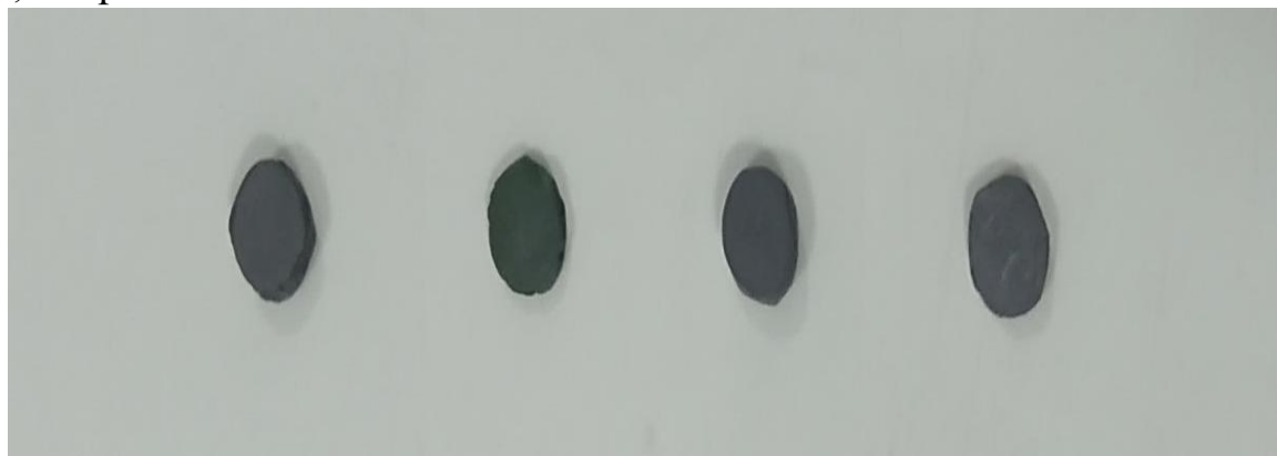
Рис. 2. Образцы из алюминиевого проводникового сплава AlV0.1 с 0.5 мас. % литием, натрием и калием для рентгенофазового анализ
