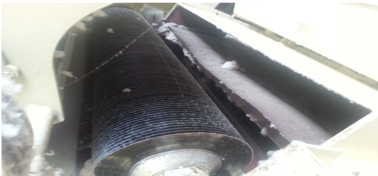
Рисунок 3.– Пильный цилиндр автоматизированной волоконотделительной машины
