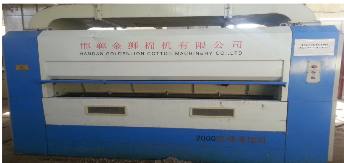
Рисунок 2.– Пильный джин (автоматизированная волокноотделительная машина)
