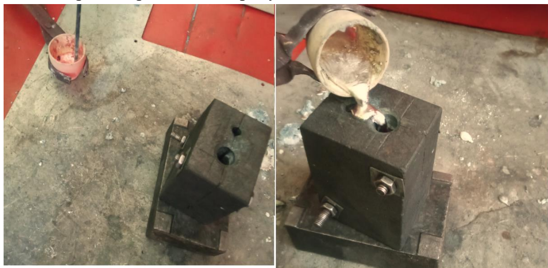
Рис. 3. Синтез сплава Al+0,1мас. %V с кальцием, стронцием и барием
