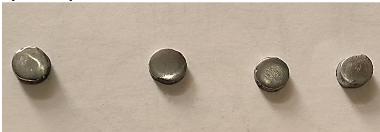
Рис. 2. Образцы из алюминиевого проводникового сплава AlV0.1 с 1,0 мас. % кальцием, стронцием и барием для рентгенофазового анализа
