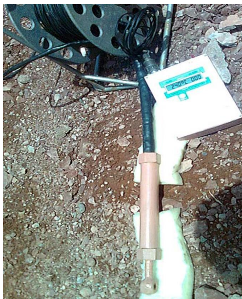
Рис. 2. Кондуктометр в сборе
